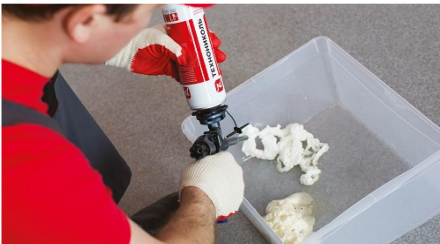
Отверните регулировочный винт пистолета, нажав на спусковой крючок, стравите некоторое количество пены в контейнер.
